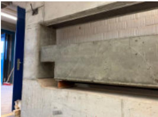
*Bild: Rissbalken, an dem die Instandsetzung von Rissen geübt wird*
